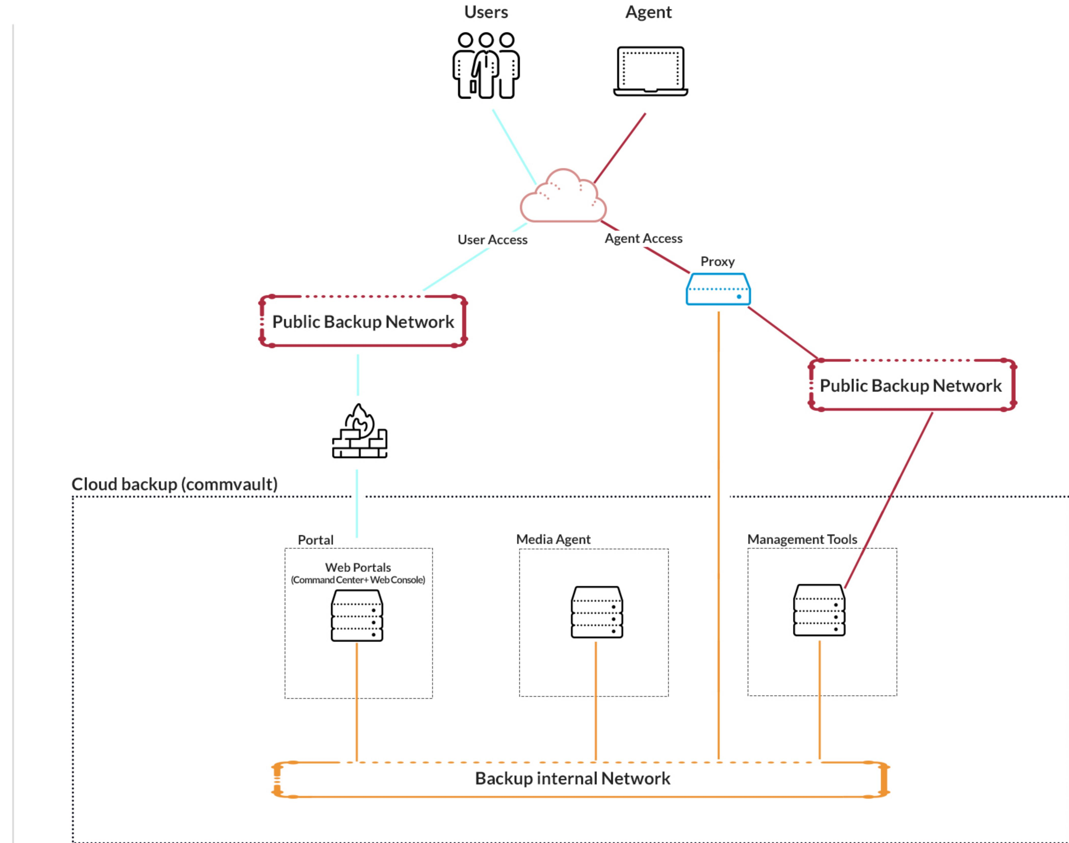
Služba Cloud Backup založená na technológii Commvault je prístupná používateľom cez verejnú sieť chránenú bránou firewall a prostredníctvom agenta, ktorý používa balancované pripojenie proxy cez verejnú sieť v kombinácii s internou sieťou zálohovacej infraštruktúry. Služba je prístupná prostredníctvom webového portálu, ktorý umožňuje vykonávať základné operácie, a prostredníctvom agenta spusteného na serveroch správy, ktorý je pripojený k dátam služby.
