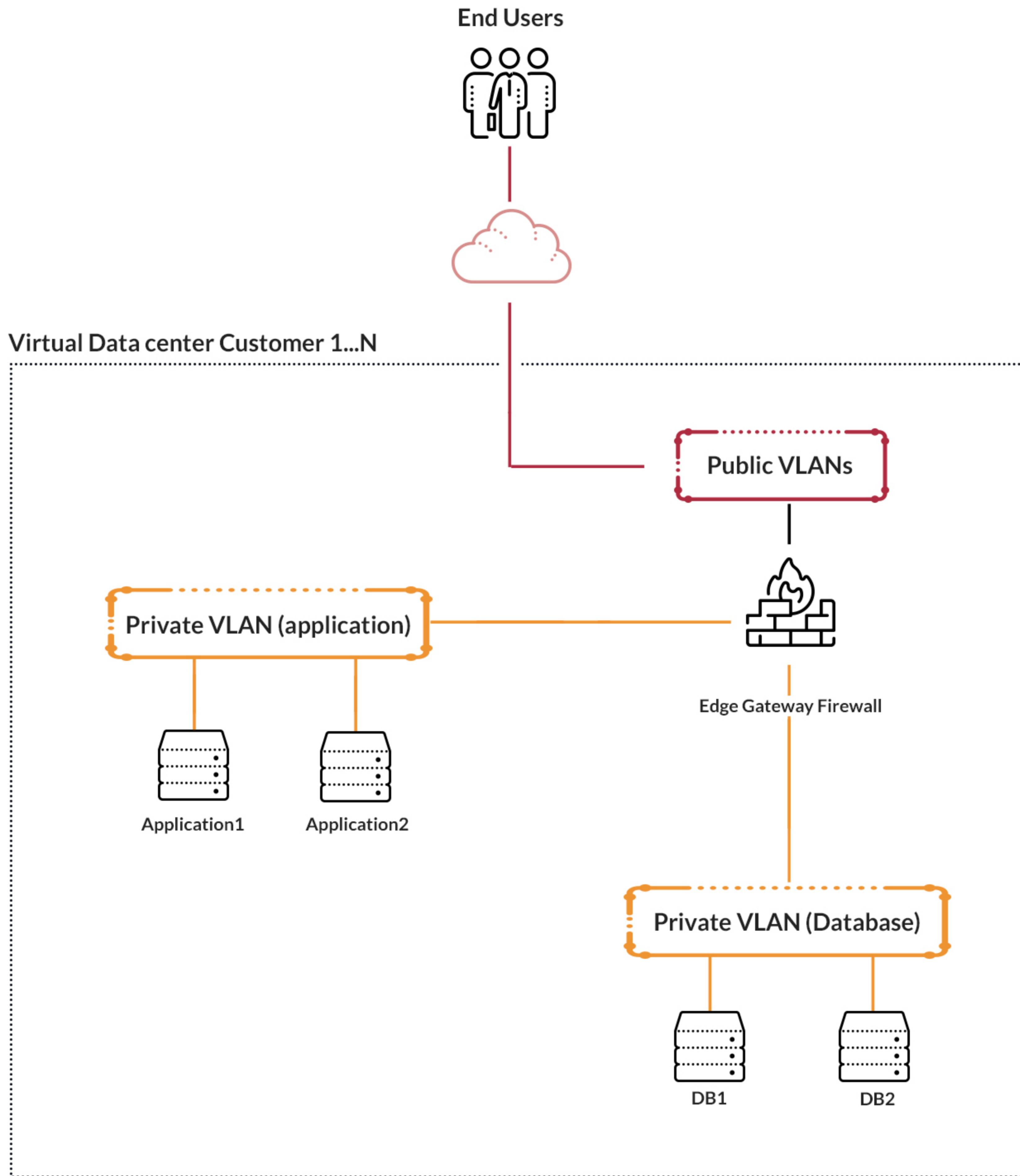
Toto schéma zobrazuje příklad základní konfigurace virtuálního datacentra (VDC). Služba se může skládat z privátní sítě VLAN pro aplikace, privátní sítě VLAN pro databázi a veřejné sítě pro komunikaci s Internetem. Jedná o velmi zjednodušený příklad: zákazník má naprostou volnost v konfiguraci VDC podle svých představ.
